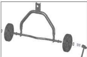
B. Části rámu spojte pomocí šroubů tak, aby noha s kolečky byla na straně rámu, kde se nachází hřídel motoru.
