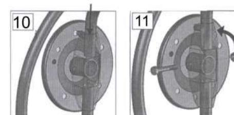
H. Nasuňte motor na hřídel a zajistěte.
